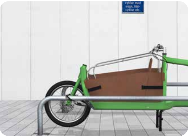
Låga cykelbågar blir tydligt dedikerade till lastcykelparkering eftersom dessa inte kan användas som stöd av standardcyklar. (Bild: BAJKE för lastcykel)
