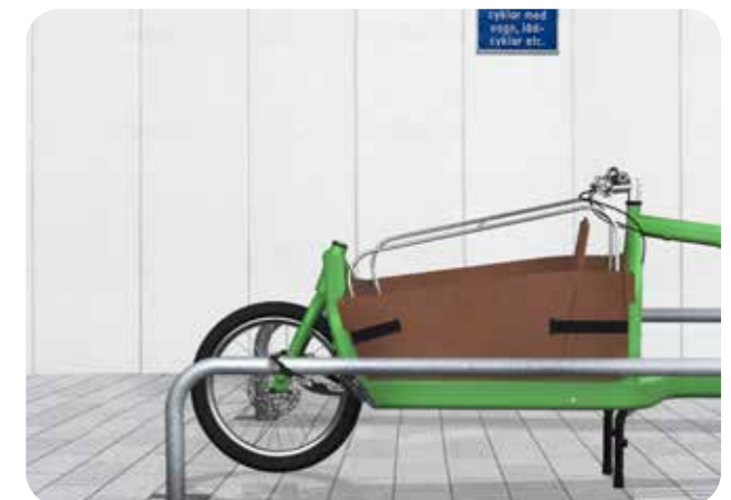
Låga cykelbågar blir tydligt dedikerade till lastcykelparkering eftersom dessa inte kan användas som stöd av standardcyklar. (Bild: BAJKER för lastcykel)
