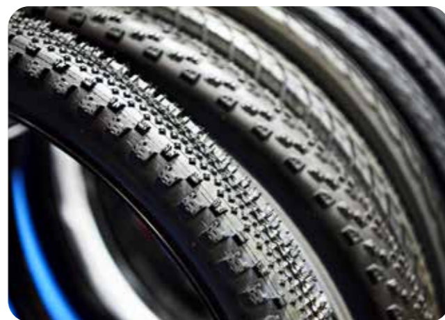
Vanliga däckbredder: racercyklar: 18-28 mm, standardcyklar: 25-40 mm, gravelcyklar: 28-42 mm, mountainbikar: 40-80 mm, fatbikar: 95-120 mm
