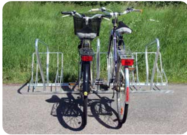
Varannan hjulhållare i olika höjd, även kallad konfiguration "hög/låg", låter cyklar parkeras med kortare c/c-avstånd eftersom styrena då hamnar omlott. (Bild: STELLA)
