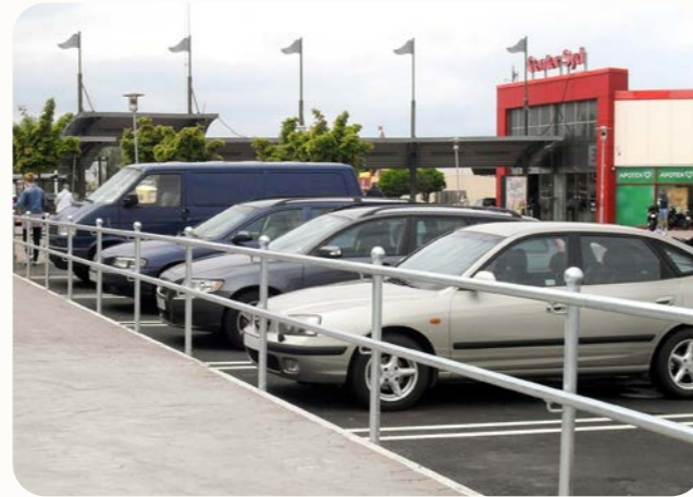
Räcket motverkar att fotgängare genar över parkeringen och minskar därigenom risken för påkörningsolyckor. (Bild: FLEXI)
