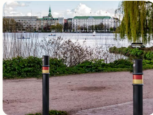
Pollare låter cyklister passera obehindrat medan de stänger ute biltrafik. Demonterbara pollare kan tas bort temporärt, till exempel vid snöröjning. (Bild pollare BIX)
