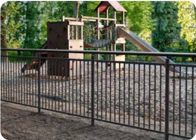
För testning av barnsäkerhet enligt standard SS 13126-5 används ett öppningsmått på maximalt 89 mm. (Bild: OPTI spjälmodul)
