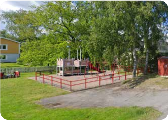
Ett räcke som inrusningsskydd skyddar mot att barn av misstag springer i de som gungar. (Bild: ADAPTER)
