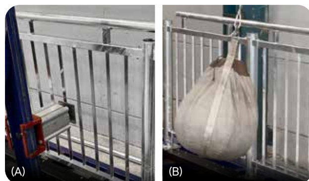
Testning av räcke vid dimensionering enligt TRVINFRA-00338.
